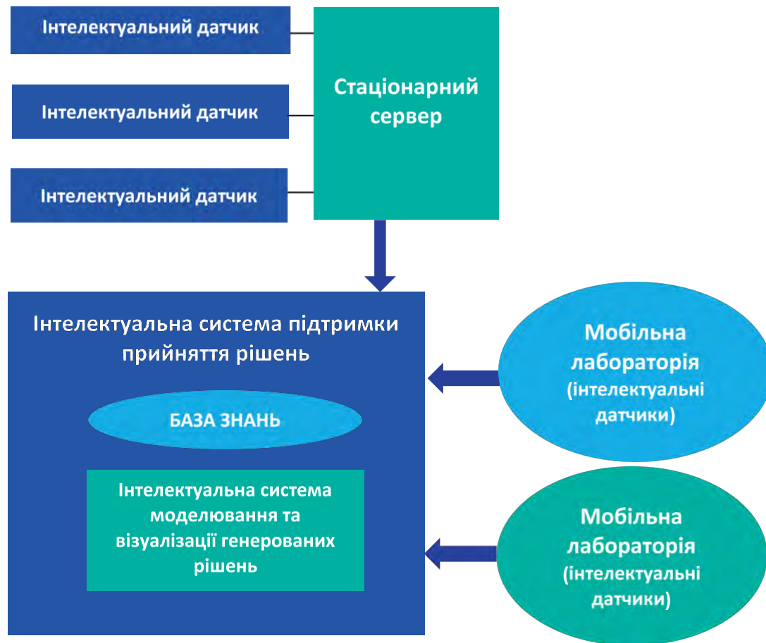
Рисунок 2. Структурна схема інтелектуальної системи підтримки ухвалення екологічних рішень для забезпечення водної безпеки
